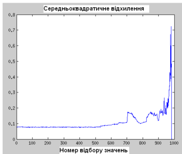
Рис. 2. Динаміка зміни середньоквадратичного відхилення вібропереміщення підшипника 1
